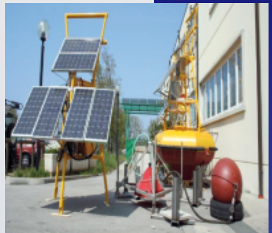
Figura 2 Boa di monitoraggio alimentata da pannelli solari, con galleggianti e dispositivo per il campionamento del gas sul fondo del mare.
